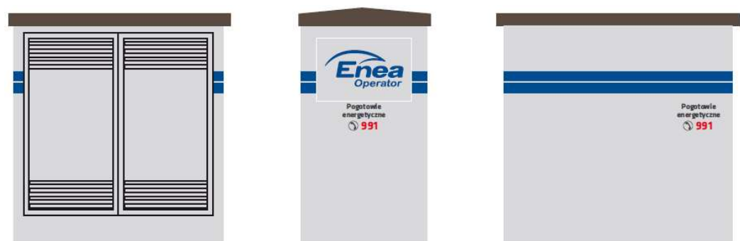
Rysunek nr 5. Kolorystyka złącza/szafy kablowej SN
